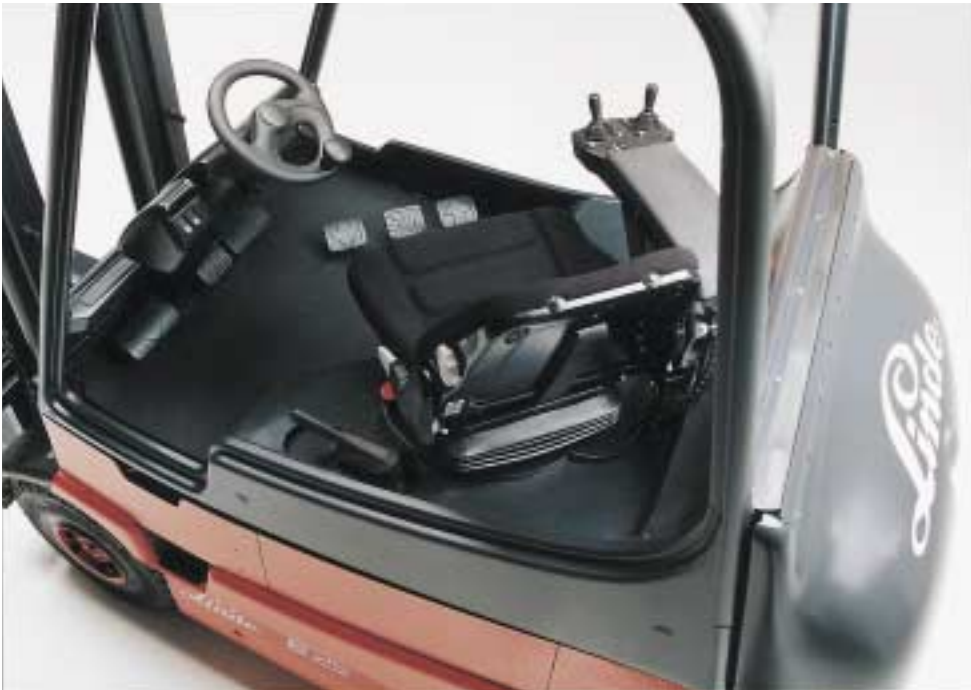
Bild 7-18: Drehbarer Fahrersitz – System „Linde“
