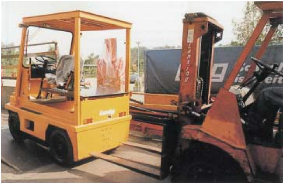
Bild 7-1: Das Verschieben von Gegenständen mit den Gabelzinken ist unzulässig
