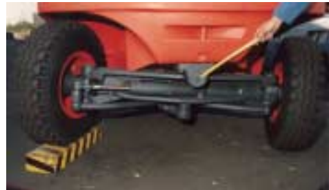
Bild 7-24: Da beim Vierrad-Gabelstapler die Hinterachse als Pendelachse ausgeführt ist, erfolgt nur eine einzige mittige Unterstützung der Last, nämlich im Lager der Pendelachse
