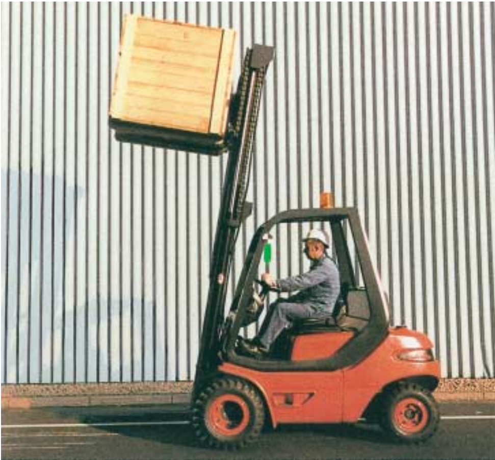
Bild 7-22: Verlagerung des Gesamtschwerpunktes bei angehobener Last
