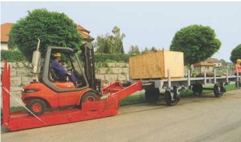
Bild 9-6: Rangieren mit dem Gabelstapler. Die Person rechts gibt dem Fahrer über Funk die Rangiersignale
