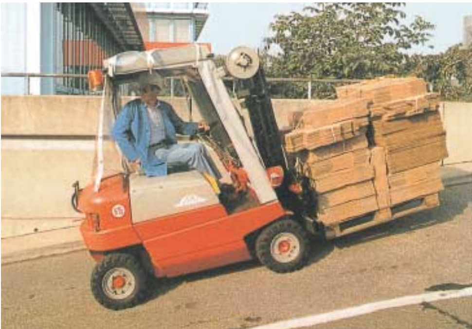
Bild 7-23: Last immer bergseitig führen
