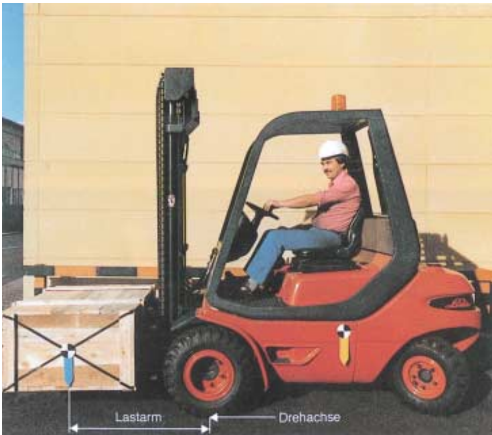
Bild 7-8: Schwerpunkte des Gabelstaplers und der Last
