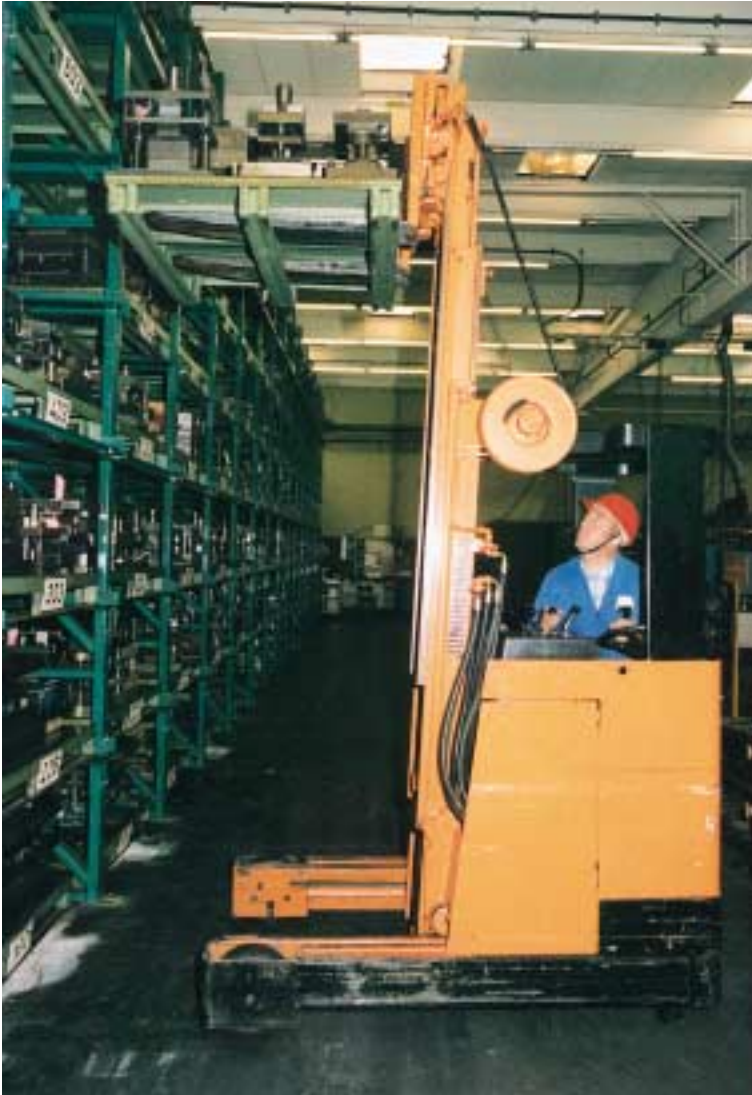
Bild 7-15: Nur zum Auf- und Absetzen mit hochgestellter Last verfahren. Hubgerüst nur über der Stapel- fläche nach vorne neigen
