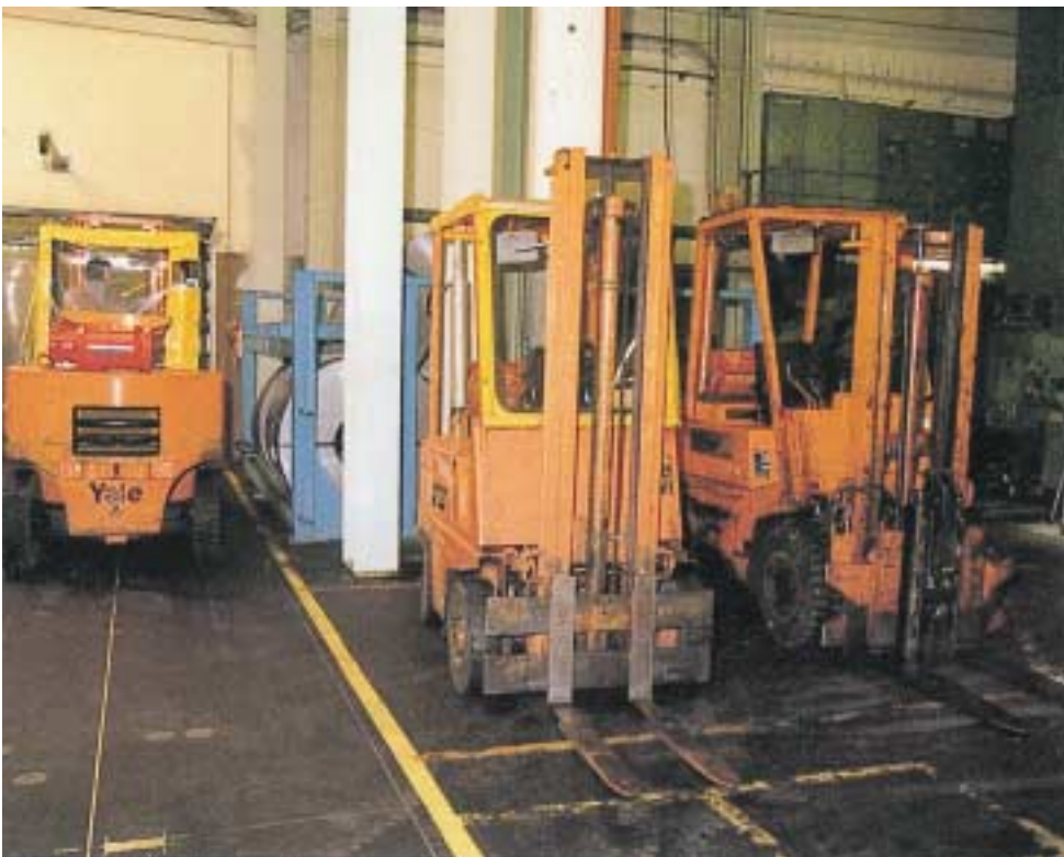
Bild 8-3: Gabelstapler nur an dem dafür vorgesehenen Platz abstellen
