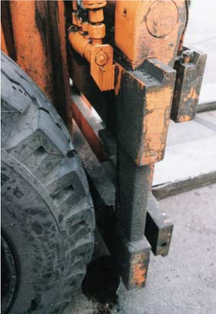
Bild 6-1: Undichte Hydraulik und Fremdkörper im Reifenprofil
