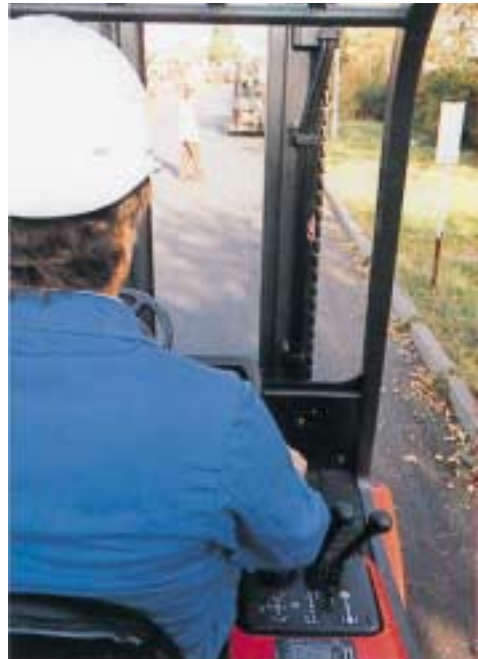
Bild 3-5: Optimal angeordnete Stelleile und bessere Sicht durch ein Freisichthubgerüst gewährleisten ein ermüdungsfreies Arbeiten
