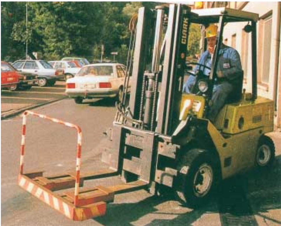
Bild 9-9: Gabelstapler mit Sonderausstattung und Warnbalken auf den Gabelzinken, zugelassen für den Verkehr auf öffentlicher Straße
