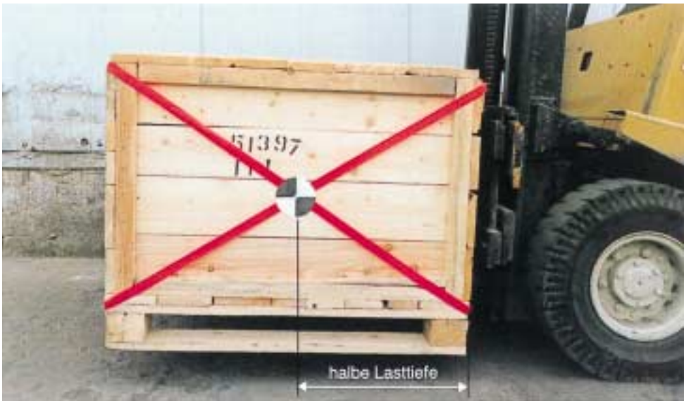
Bild 7-5: Der Schwerpunkt der Last liegt in der Regel auf halber Lasttiefe
