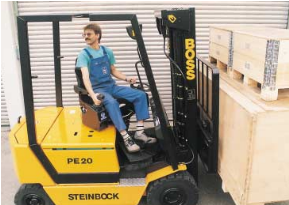
Bild 7-17: Drehbarer Fahrersitz – System „Steinbock“
