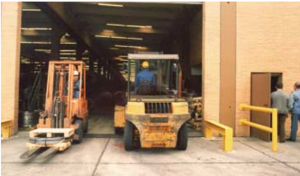
Bild 7-4: Trennung von Fahrzeug- und Personenverkehr. Zwischen Gabelstaplern Sicherheitsabstand mindestens 0,4 m, zu den Torbegrenzungen mindestens 0,5 m
