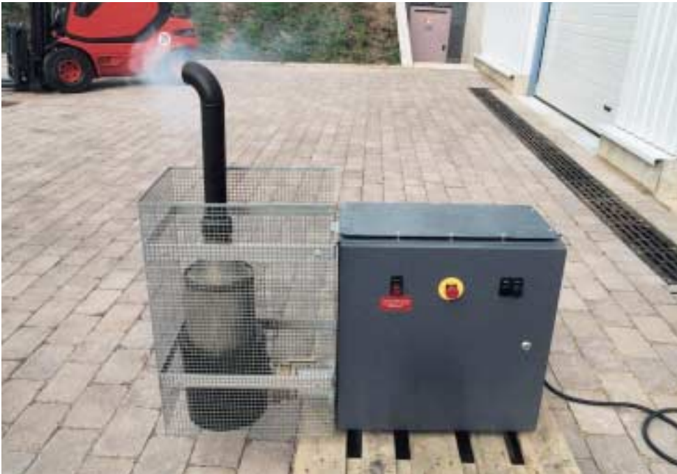
Bild 4-2: Regenerationseinrichtung für Rußfilter (Filterreinigung dauert ca. 30 Minuten)
